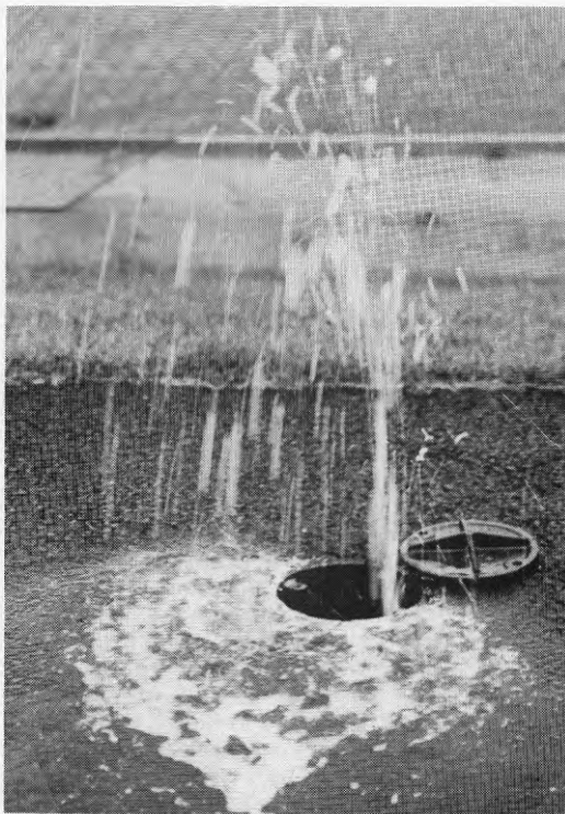
Figur 6.12 Skum bildat av salt, vatten och luft vid luftning av markackumulatorn.
