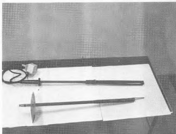
Fig.2.1a Elspräckare att kopplas till svetstransformator, 40 V.
