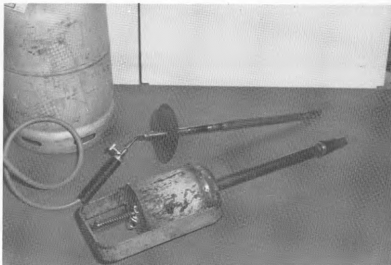
Fig. 3.1 a. Gasdriven stenspräckare tillsammans med patronladdad stenspräckare, som används alternativt med kilning för särläggning av förspräckt stenmaterial.
