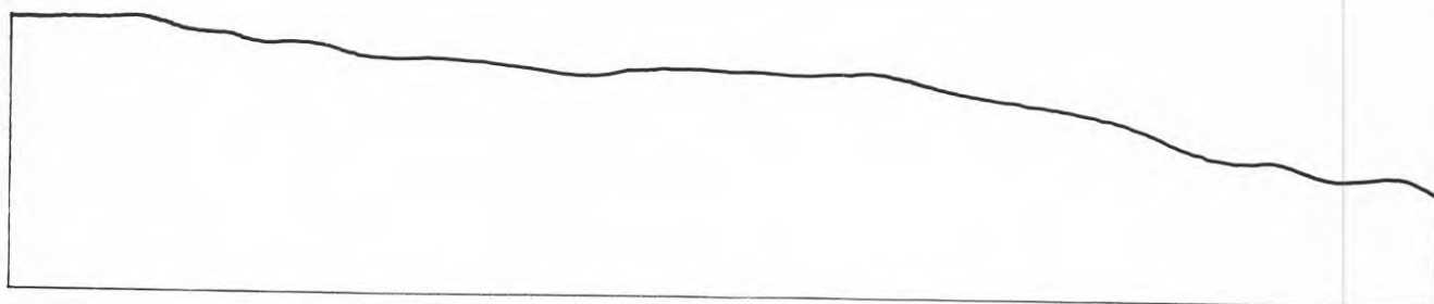
Profilkurva genom ytan. Skala 5:1. Exempel på ytans amplitud eller djup.
