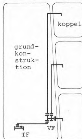
FIG 9. Modulindelning av Rörssystem-BPA i trevåningshus
