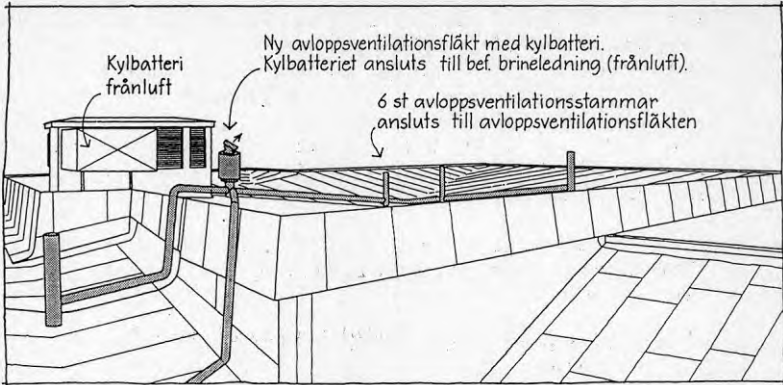
Anslutning av avloppsventilationsfläkt på tak.
