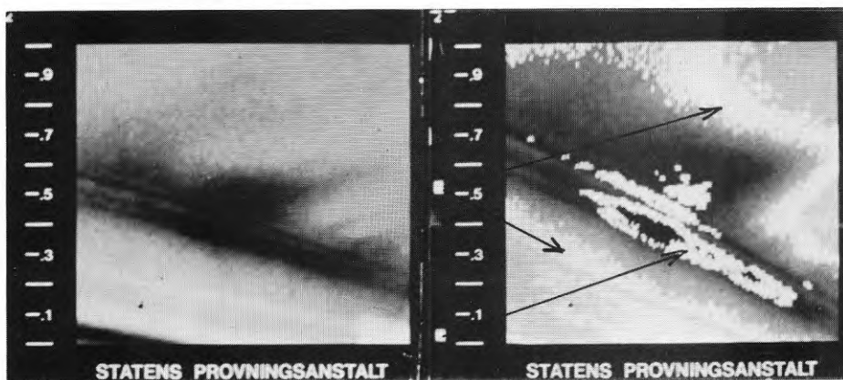
c) Termogram av samma ytparti som vid b) med två isotermer inlagda (isotermbild).
