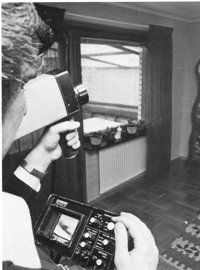
a) Termografering med IR-kamera av vägg- och takparti. Värmebilden återges på oscilloskåpets bildskärm.
