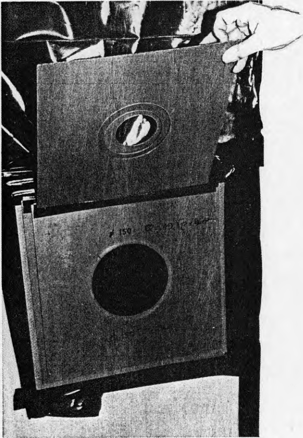
FIGUR 2 Bländare med diameter 150 mm och bländar- konstant = 49.0
