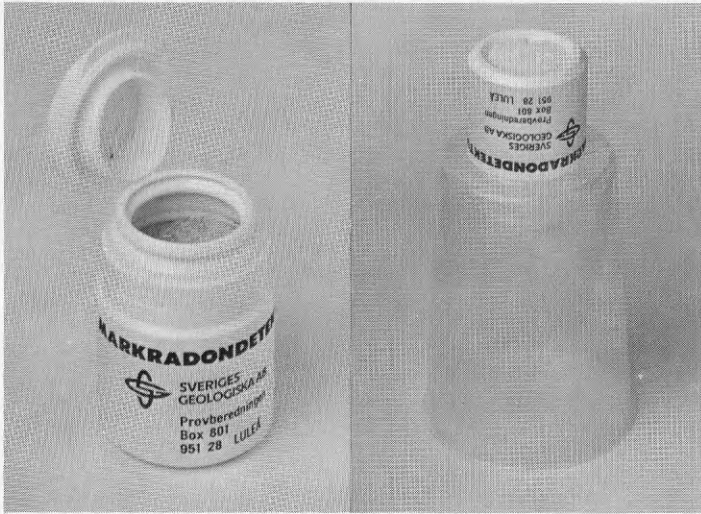
Figur 5.5 SGABs markradondetektor enligt ROAC-metoden.
