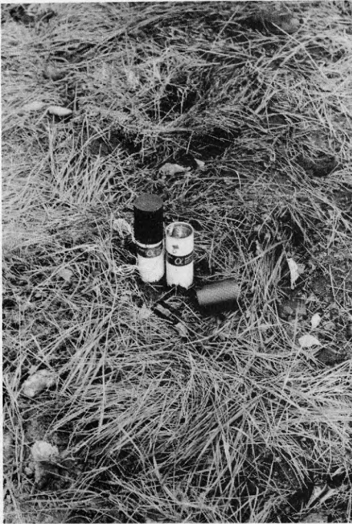
Figur 5.11 Markradonmätning med alpha-METER.
