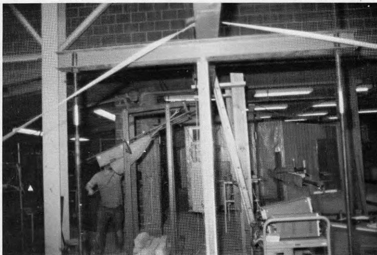
Bild 12. Prov med fallande sandsäck. Till vänster i bilden släpps säcken mot dämparen av cellplast som vilar mot väggen med centrum ca 15 cm från regel. På baksidan av väggen registreras försöket med lägesgivare och transientrecorder.
