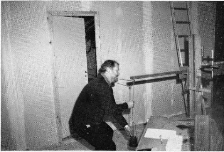
Bild 9. Dörrslagningsprov med 10 kg:s vikt. Dörren öppnas 90°. Vikten som drar igen dörren, når golvet strax innan dörren stängs.
