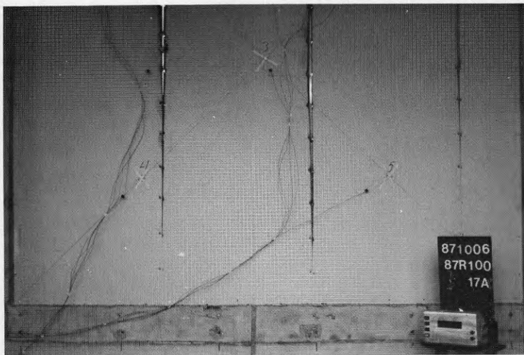
Bild 16. Brandprov vägg A. Väggens uppfyller inte längre kraven för brandavskiljning efter knappt 30 minuters provtid.
