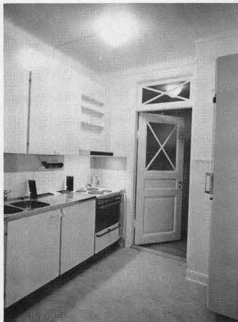
Övergång från gas- till elspisar, mer maskinell utrustning, ökad belysning etc. kräver ökad elkapacitet.
