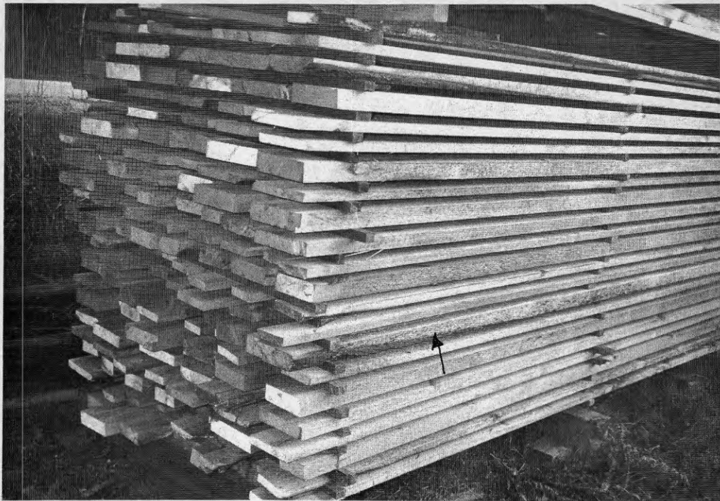
Brädgårdsstaplat virke börjar mögla vid splintvedkanter eller t.o.m. invid vankant med bark mitt på stapelns hitsida. Regnskyddet är otillräckligt för stapelns yttersta bräder.
