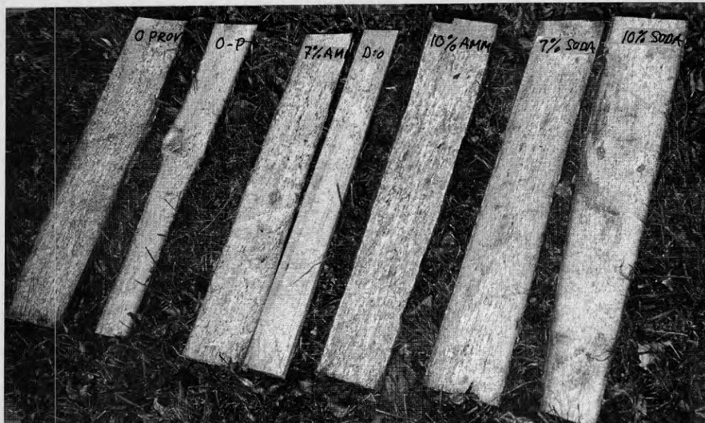
En månad efter uppsågning hade bakar ställda under tak möglat; Från vänster Nollprov, Kalk (för tunn bak), 3 ammoniak & 2 soda
