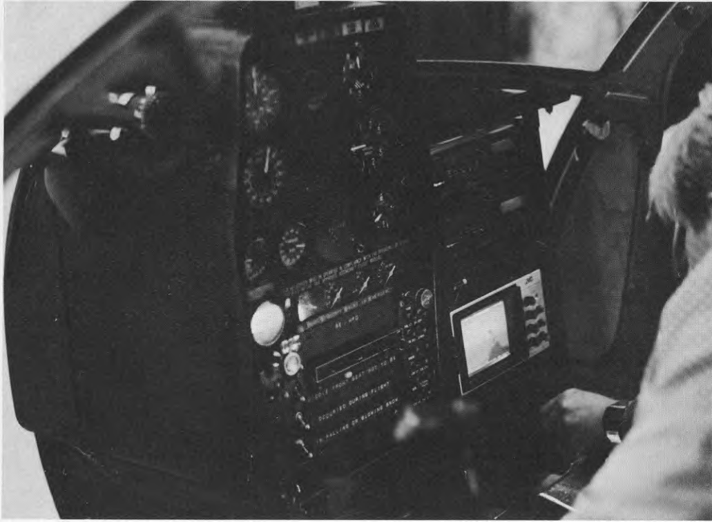
Figur 2:1. Installation i helikopter Hughes 500C av styrenhet och monitor för kraftledningsinspektion.
