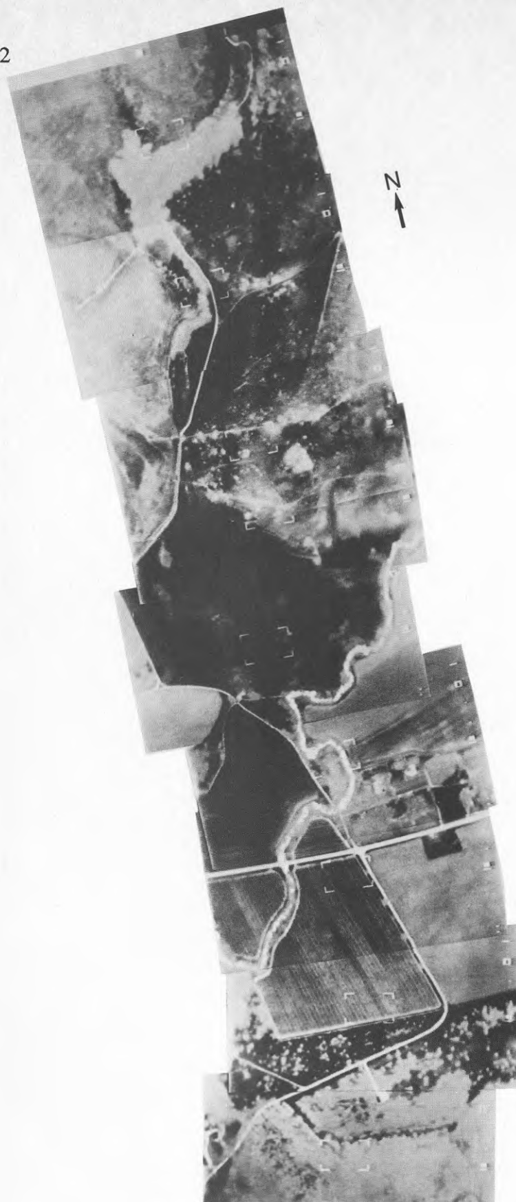
Figur 5:9. Montage av värmebilder registrerade med FLIR-systemet över försöksområdet vid Verkaåns dalgång. Ljusa ytor i registreringen är varma.
