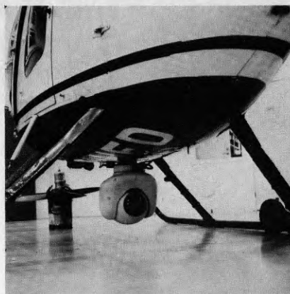
Figur 2:3. FLIR-systemet upphängt i helikopterns lastkroksinfästning.
