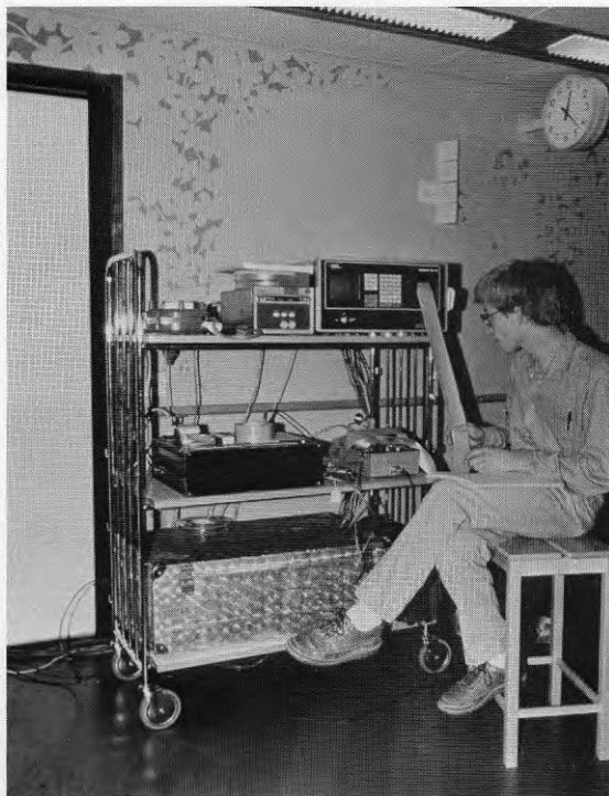
Bild 6 Registrering av temperaturer med datalogger
