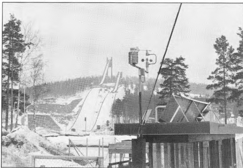
Fig 9.10 Biljett-entrén för bandybanan där givare för lufttemperatur, luftfuktighet, vindhastighet och vindriktning monterats i en mast ovan tak.
