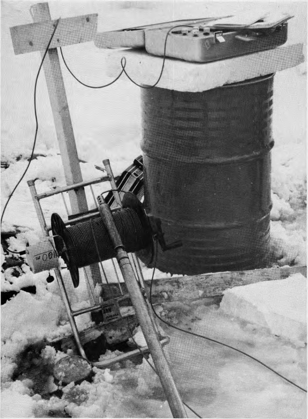
Figur 3.7 Mätutrustning för inmätning av borrhål
