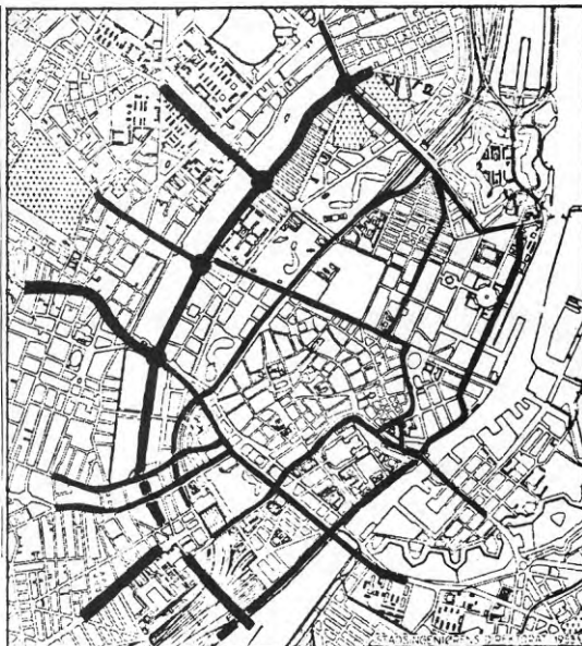
Fig. 161. Skiss till genomfartsleder i Köpenhamns City från generalplanskissen 1954. De tjocka vägarna är primärleder, d.v.s. "Sjöringen" längs sjöarna, och de viktigaste radiella infartsledningarna. De tunnare vägarna är cirkulationsgator inom City.
