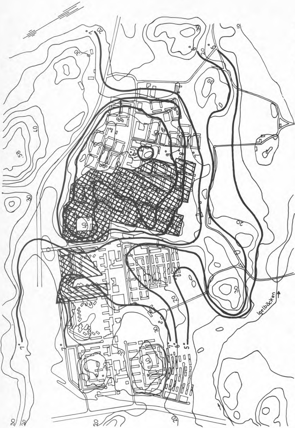
FIG 42. T min natten till 28 augusti 1973. Inga hus var byggda, inom det streckade området var skogen avverkad och inom det inrutade området hade grundarbetena påbörjats.
