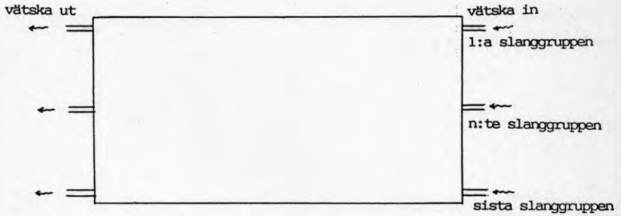
Figur 4.1 Plan över markvärmelager med slangar.
