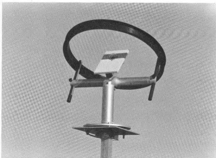
Figur 6.3 Pyranometer med skuggring.
