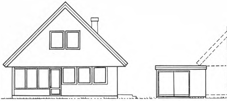
Fig. 1 Typisk placering av garage eller carport och förråd intill grannhuset.
