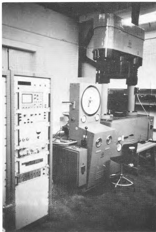
FIG. 4.5.1 Servohydraulisk universalprovningssmaskin typ Losenhausen HUS 100 med belastningskapacitet 1000 kN.
