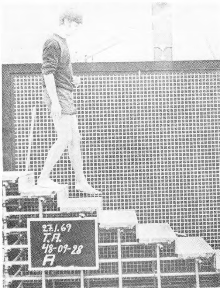
Försökstrappa 15 cm steghöjd, 30 cm stegdjup. Stegdjupet bör vara 25—30 cm. Stegdjup därutöver kan försämra balansen, eftersom särskilt småväxta personer måste ta onormalt långa kliv.
