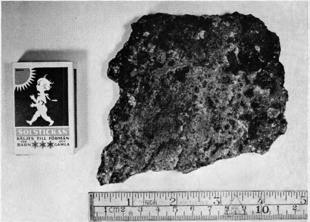
Fotografi av ett stycke av fast beläggning från en oljeeldad panna
