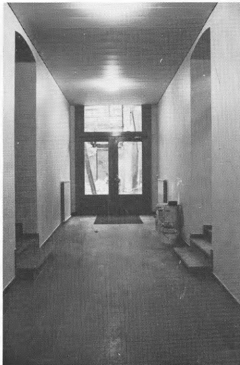
FIG 5.16 Kombination av nya lägenhetsdörrar, stänkfärgsmålning och modern belysning kan ge förödande effekter. Hisschakt och undertak påverkar den ursprungliga välproportionerade rumsvolymen
