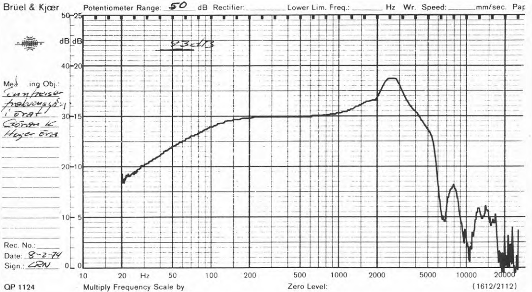
Fig 35. Ex på frekvensgång i örat (concha) för hörlur typ Sennheiser HD 414
