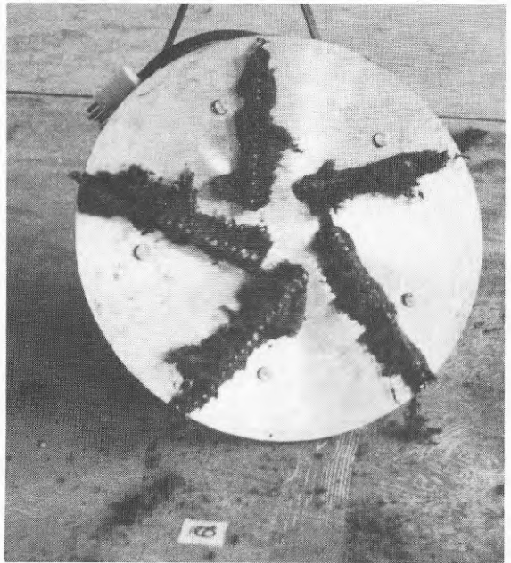
Bild 9 Verktyg för slipmaskin, skiva med stålspik. (Bildens tagen efter rensning)
