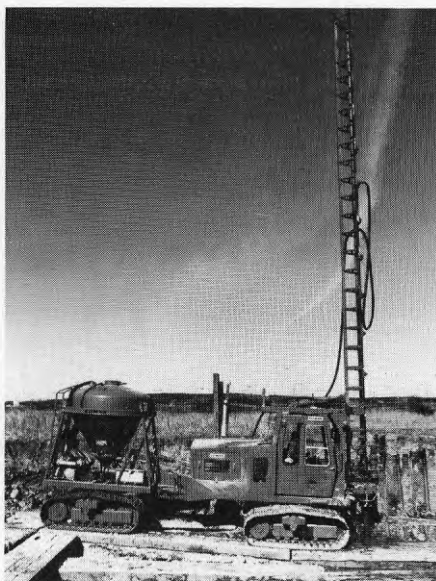
Figur 18 Kalkpelarmaskin LPS 4. Utvecklad av Linden-Alimak AB
