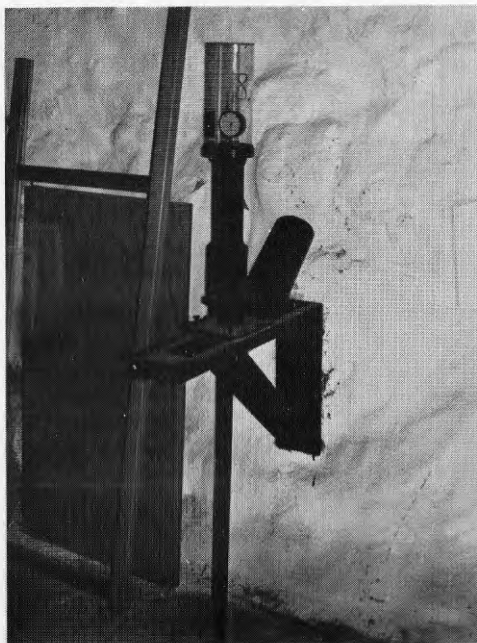
Fig 65. Sättningsmätning med fast monterad mät-klocka.
