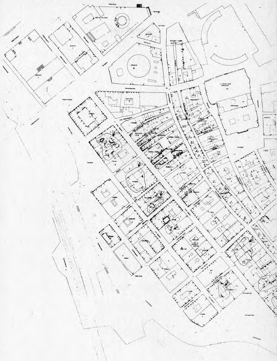
Fig. 73. Planredovisning av utvändiga sättningskador enligt utvändiga besiktningar 1978-79
