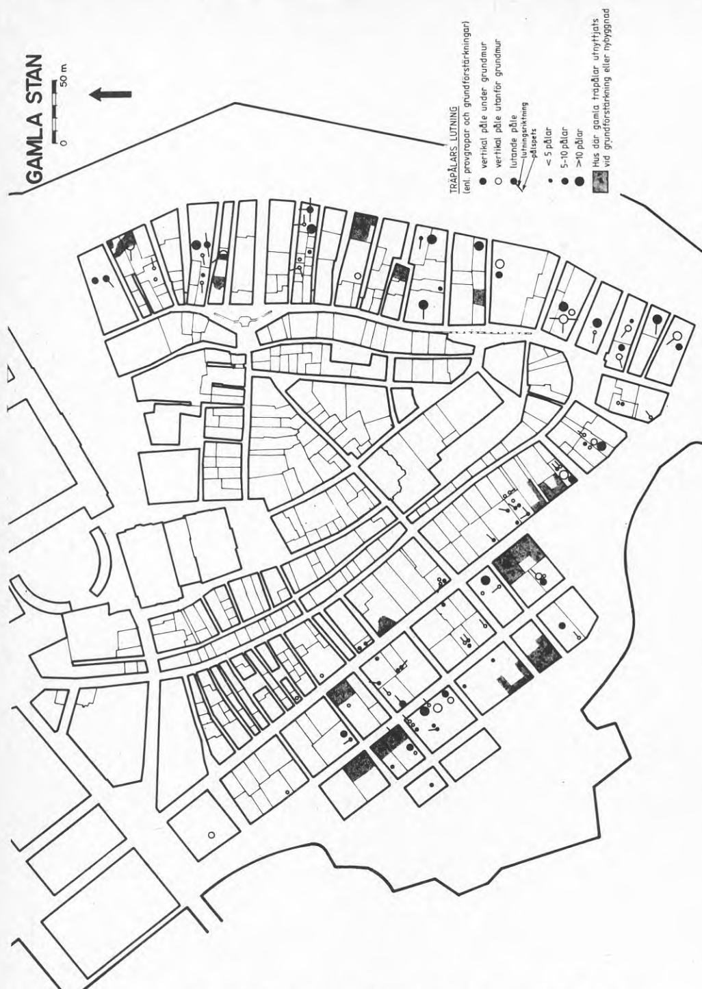
Fig 57. Sammanställning av trapålar lutning enligt informationer från provgropar och grundförstärkningar.
