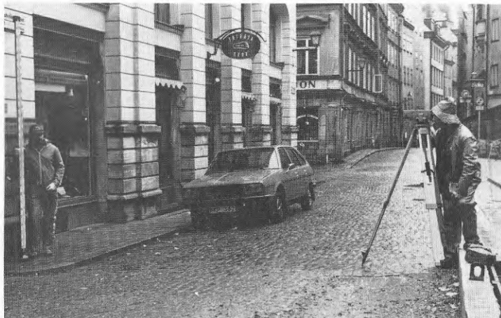
Fig 66. Precisionsavvägning av sättningsdubb i hussockel.
