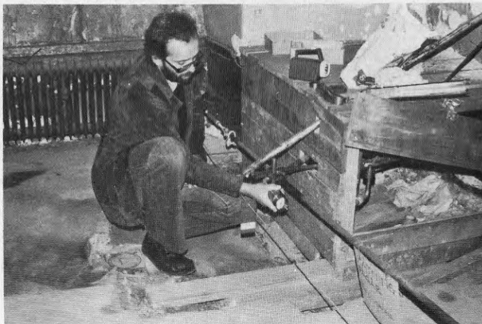
Fig 55. Husrörelser i förhållande till metallstången mäts med mätklocka.
