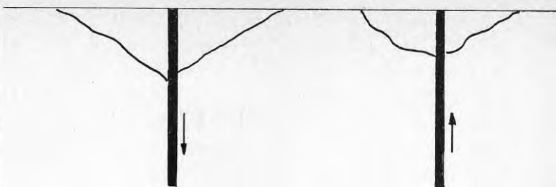
Figur 6.1 Kratereffekter vid fullt laddade 27 mm borrhål för topp- resp botteninitiering.
