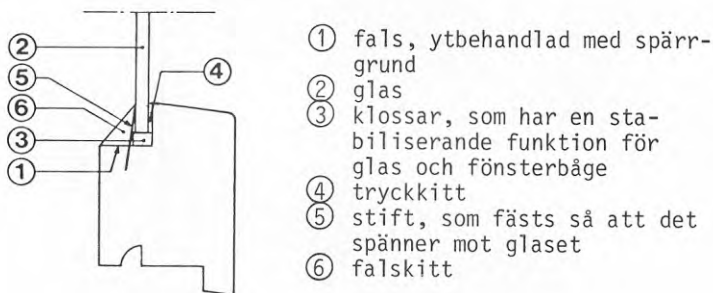
Fig 3311 Kittfalsen i bågottenstycket.
