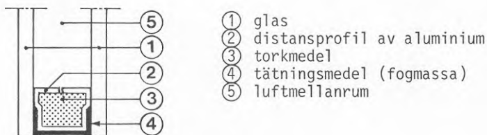
Fig 3322 Detalj av limförseglad ruta (enkelförsegling).
