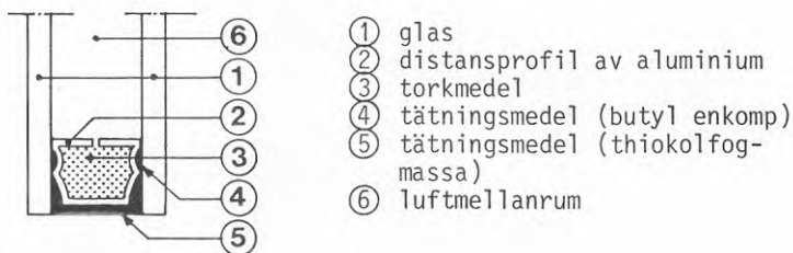
Fig 3323 Detalj av limförseglad ruta (dubbelförsegling).
