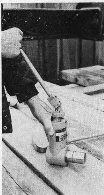
Figur 3.13 Dykarens behändiga domkraft som han använder när den undre styrningen ska pressas ut.
