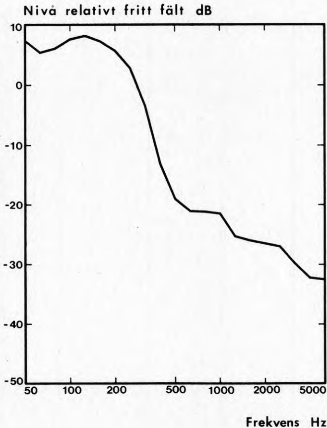
FIG. 3. Ljudutbredning över en trumlad stubbåker vid LTH i Lund. Avstånd källa-mottagare = 20 m. Källhöjd = mottagarhöjd = 0.1 m.
