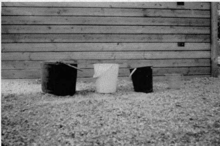
FOTO 3. MÄTKÄRL FÖR REGISTRERING AV VATTENFLÖDE. FRÅN VÄNSTER 15 l, 6 l, 5 l och 1 l.
