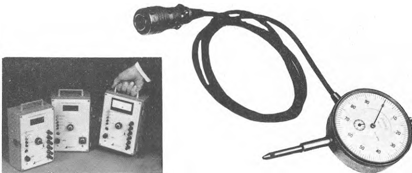
FIGUR 11. Enkla mätbryggor och exempel på en elektrisk indikatorklocka.
