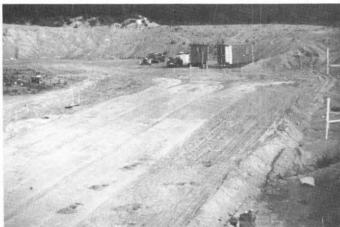
FIGUR 6 Testytan med befästa baslinjer och uppsatta höjdtiangelar (flukter). Kontors- och laboratoriebedar i bakgrunden
