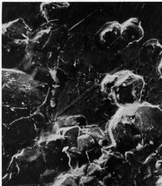
Fig 31 A = Början till korrosionsskada (x 1000)
