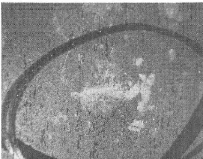
Fig 29 A = Början till korrosionsskada (x 6)
