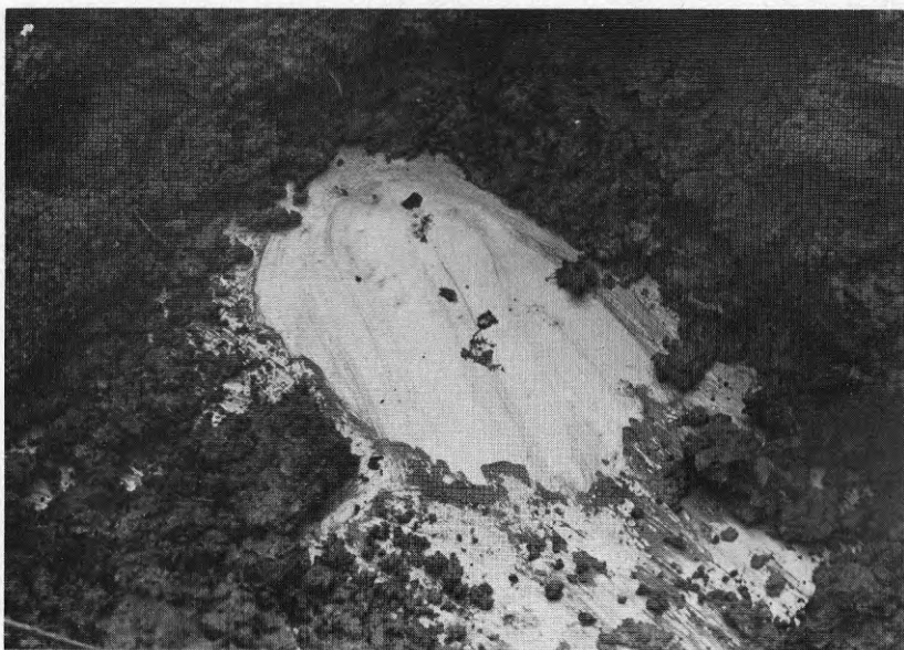
Fig 27 Korrosionsskada (genomgående hål) under lera och på kvalitet R 350
