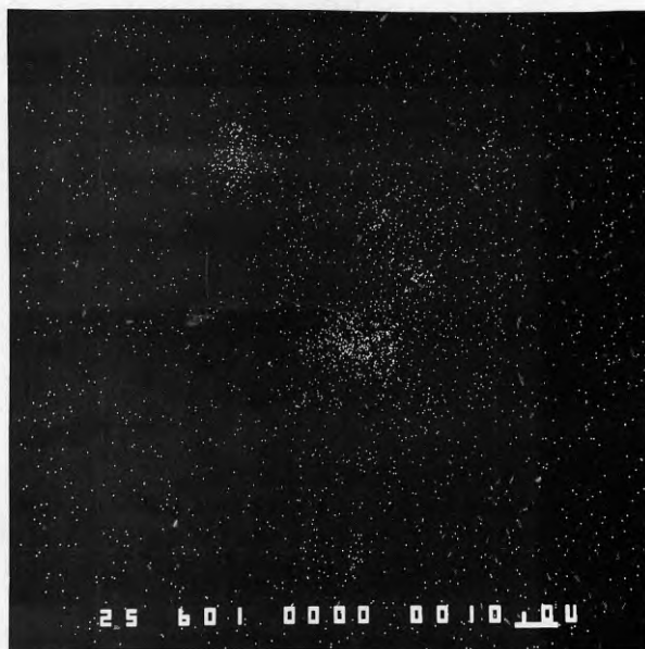
Figur 4.9. Kloridfördelning på den yta som visas i figur 4.8 (förstoring = 600 ggr). En betydande kloridanrikning märks vid korrosionsangreppet. Förutom klor har även svavel och järn kunnat påvisas i korrosionsangreppet. En liknande sammansättning kunde konstateras på partiklar som ännu ej orsakat någon märkbar korrosion.
