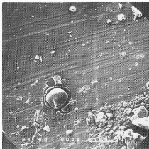
Figur 4.35. Prov från TA4 efter 5 års drift. Denna sida av aluminiumfolien har jämförelsevis kraftiga korrosionsangrepp.
