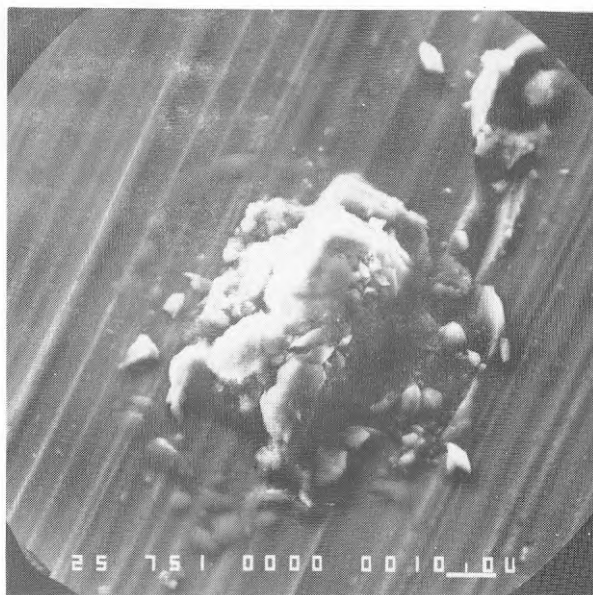
Figur 4.5. Delförstoring, 750 ggr, av området med korrosionsangrepp enligt figur 4.4. Vid angreppet uppträder kloridanrikning. Dessutom finns mindre mängder järn och svavel samt mycket små mängder kalcium och kisel.
