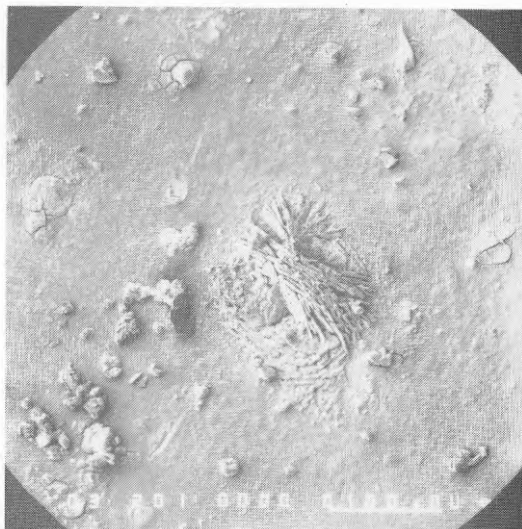
Figur 4.10. Prov av aluminiumlamell från provanläggning I efter 1 års drift. Utan filter före värmväxlare.
