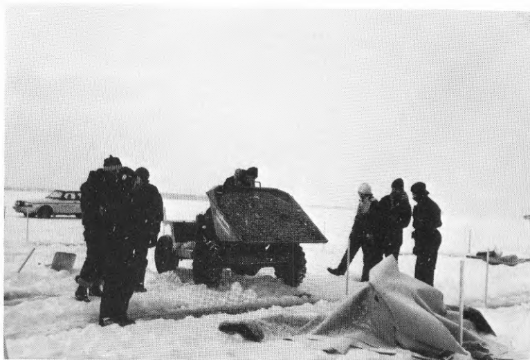
Figur 3.8 Singelbelastning med dumpers genom uppsågade spalter i isen.
