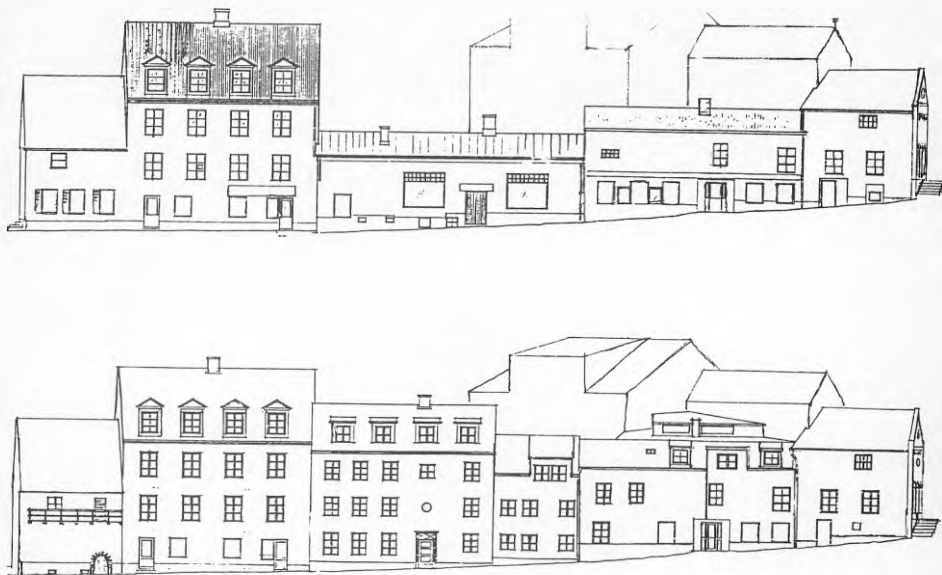
Figur 5.4 Samtliga fasader mot väster och S:a Kyrkogatan, före och efter ombyggnad.
