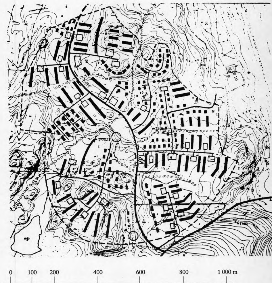
Figur 1. Planeringsexempel för bostadsområdet Rösbo: Villor, radhus, lamellhus, 900 lägenheter, 75 ha markareal, 50 re/ha (Ref 2).
