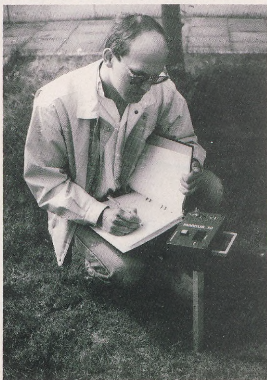
Figur 5.11 Emanometer med halvledare som radonanalysator. Instrument av typ Markus 10 tillverkat av Gammadata Mätteknik AB.
