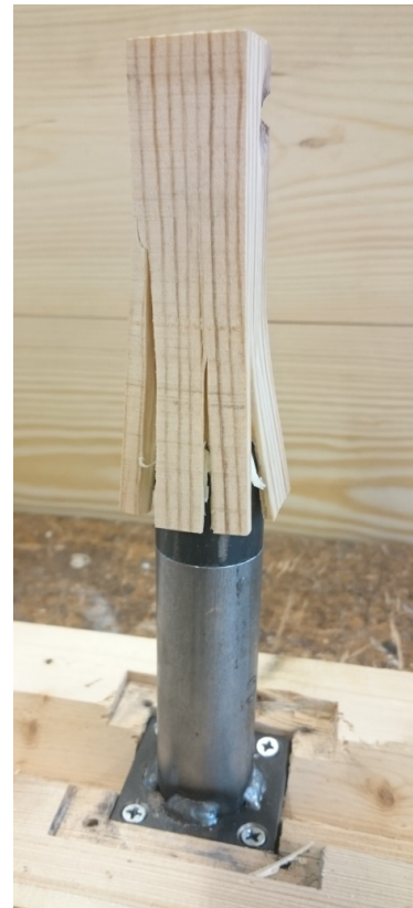
Figur 36. Driving av fyrkantiga ämnen.
