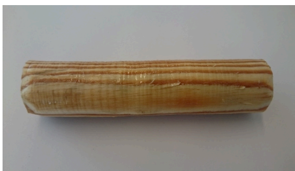
Figur 34. Tränagel med frampressade hartsämnen.
