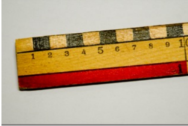
Figur 4.52 Linjal där skalan börjar direkt vid kanten av linjalen.
