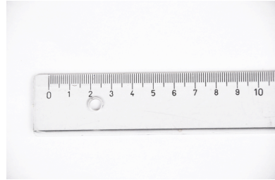
Figur 4.53 Linjal där skalan börjar en bit in på linjalen.
