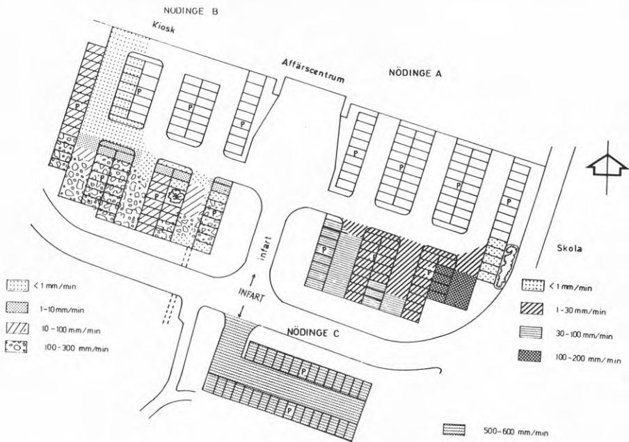
Figur 7.1:10 Resultat från mätning av den areella infiltrationen på parkeringsplats med enhetsöverbyggnad i Nödinge.
