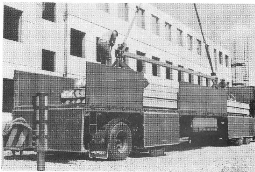
Figur 4:18 Belastning på yta C1 med tung lastbil.
