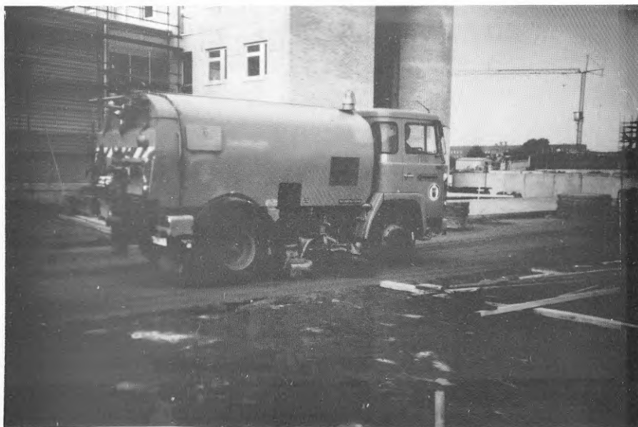
Figur 7.7:2 Rengöring av testyta C1-C2 med sopmaskin av typen Schörling med bevattning och sugupptagning av sediment. Se även figur 7.7:3
