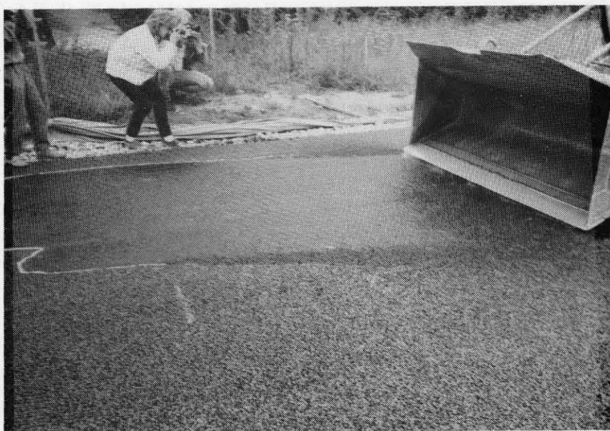
Figur 5:17 Illustration av enhetsöverbyggnadens dräneringsförmåga på Ole Römers väg. Efter 10 sekunder.
