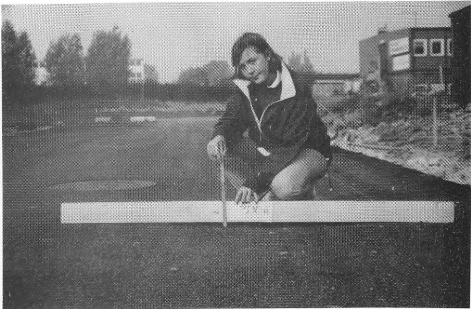
Figur 7.6:6 Exempel på spår vid sektion 395 på Ole Römers väg cirka 6 månader efter öppnande.
