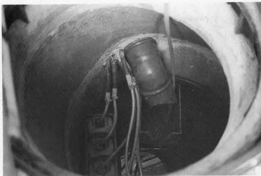
Figur 4:16 Mätöverfall och dräneringsslangar med provtagningsflaskor i yta C3.
