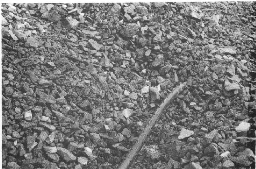
Figur 4:15 Dräneringsslang för provtagning av vattenkvalitet.
