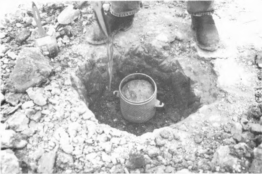
Figur 5:15 Ostörd provtagning av provkropp för CBR-mätning på Ole Römers väg.
