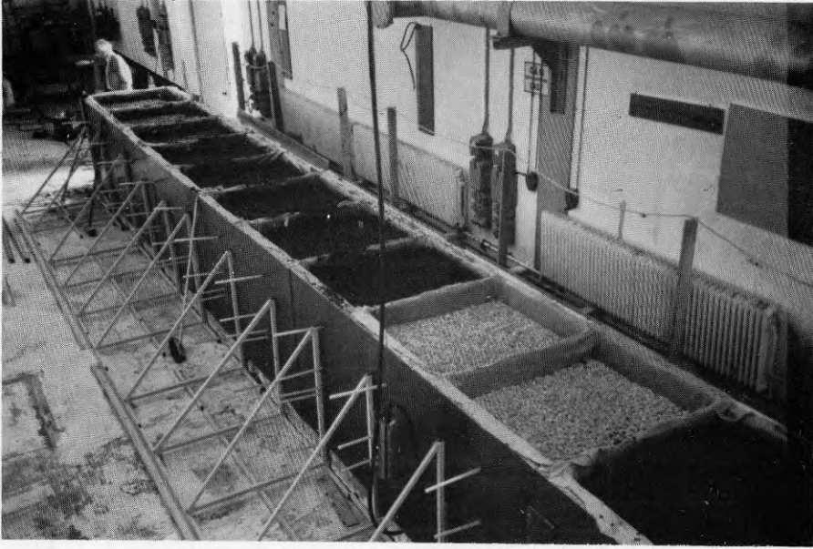
Figur 3:13a Testboxar för laboratorieförsök med enhetsöverbyggnad. Provtagningsrören framgår i bilden.
