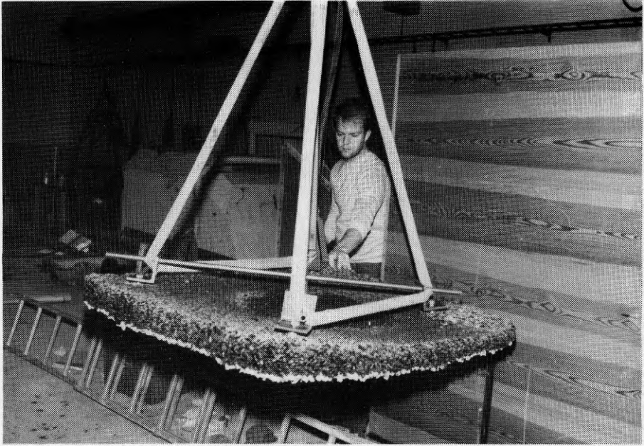
Figur 7.2:3 Avlägsnande av beläggning från testbox.
