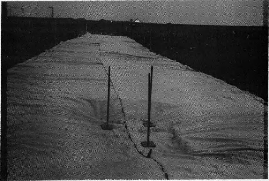
Figur 3:3 Vattenståndsrör placerade i fördjupning
