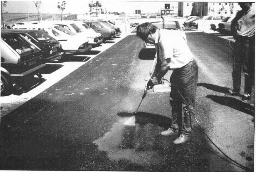
Figur 3:10 Försök med högtryckspolning på testyta C1 i Lund.
