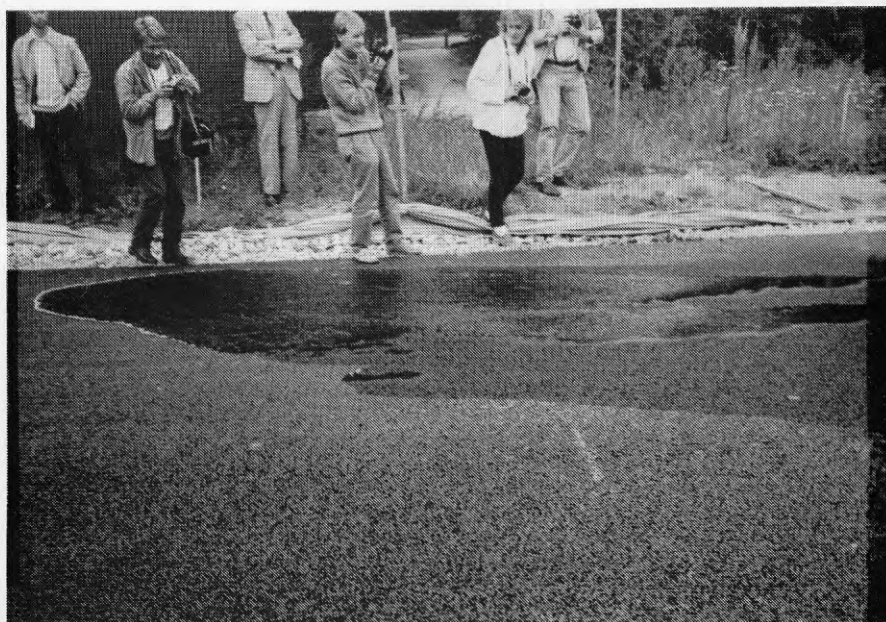
Figur 5:18 Illustration av enhetsöverbyggnadens dräneringsförmåga på Ole Römers väg. Efter 15 sekunder.
