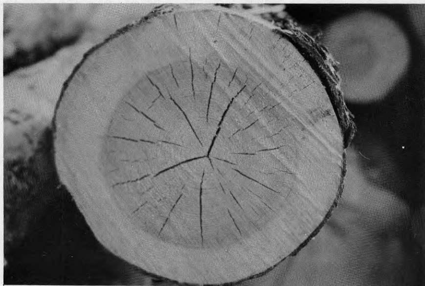
Figur 8.2 Årsringsbredden avgör till stor del virkets kvalitet. Vid 1-2 mm årsringsbredd är virket tyngst och starkast.
