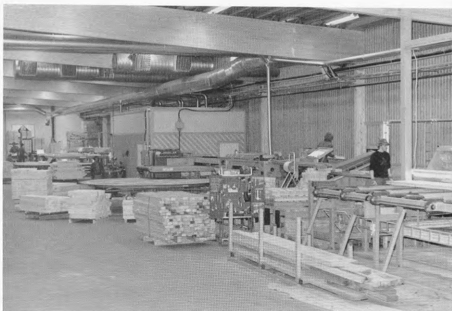
Figur 5.5 Vid ämnestillverkning ökar virkesutnyttjandet samtidigt som risken för oönskade fel hos den färdiga produkten minskar.
