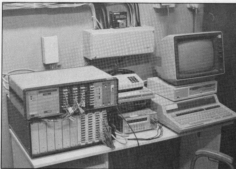
Fig 5.1 Hela centralutrustningen med dator, voltmeter, mätpunktsväljare, räknarenhet etc.
