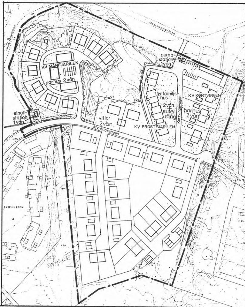
Figur 6.6 Alternativ skiss till detaljplan med liten bundenhet till ursprungliga gränser och med tillskapande av gemensam yta i kvarterets inre.
