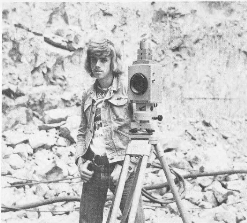
Fig. 4. Fotogrammetrisk mätkamera Zeiss TMK, negativformat 9 x 12 cm. Kameran horisonteras noggrant med en libell med magnetisk vidhäftning (överst).
