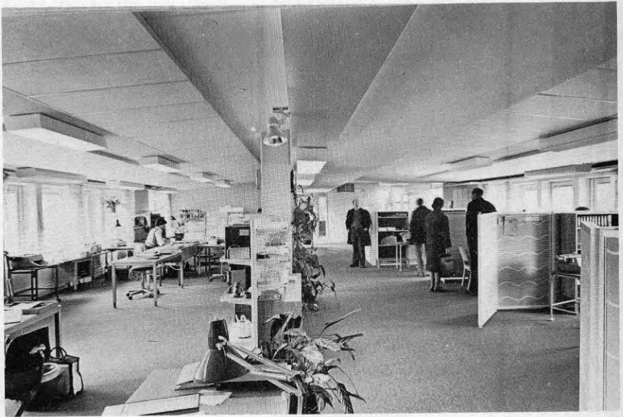
Figur 5.18 Östra Malmen Storrumskontor i översta våningen som har sluttande tak vilket ger ett intimt rum vid fasaden. Husbredden är 11,5 meter. Med fönster på ömse sidor och en måttlig skärminredning har man ofta möjlighet att släcka lamporna, särskilt i ytterzonerna.
