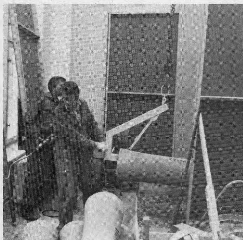
Figur 4.10. Lyftgalge med säkerhets-spärr, fjäderbelastat lyft och manöverhandtag. Rehmans Smide, Södertälje.
